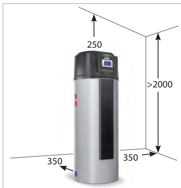
Obr. 8: Minimální vzdálenosti v mm
